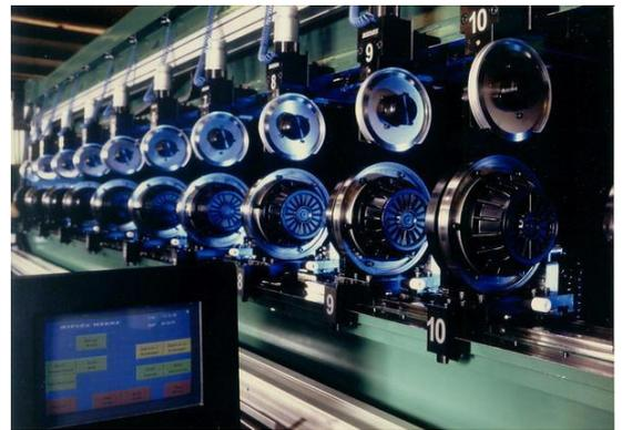
**Messerhalter DS 8 easy change / werkzeugloser Messerwechsel**
