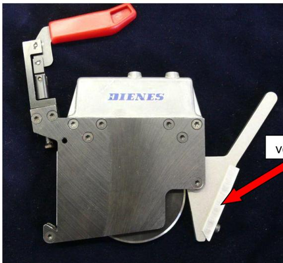
1. Schwenkbar für Messerwechsel
